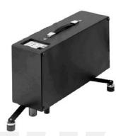
Máquina de impactos normalizada. Brüel & Kjaer 3207. Medición in situ del aislamiento acústico de suelos al ruido de impactos conforme a la norma UNE-EN ISO 140-7.
