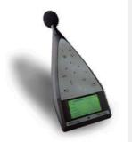
Sonómetro integrador 2238 y calibrador 4231 (Brüel & Kjaer)
