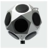
Fuente de ruido ominidireccional, se compone de doce altavoces, con potencia de emisión sonora de hasta 122dB, conectada a generador amplificador de ruido rosa y blanco, todo ello de la marca Brüel & Kjaer)
