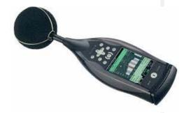
Sonómetro integrador 2270 y calibrador 4231 (Brüel & Kjaer)
